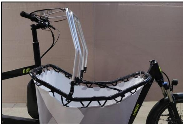
Zu Beginn der Montage setzen Sie die 2 Schellen der Aluminiumbügel hinter dem hinteren Knick im Kids Frame auf den Frame auf. Die Gasdruckfeder befindet sich dabei vorne rechts.
