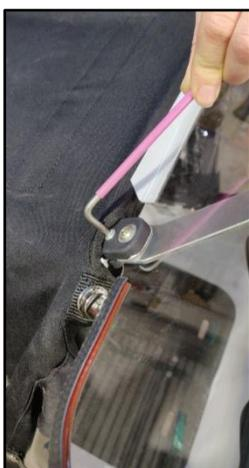
Das Visier kann in seiner Neigung verstellt werden. Sollte diese Verstellung zu schwer- oder leitgängig sein, kann sie mit Hilfe eines 3 mm Inbus an der unteren Schraube der Befestigungsschelle angepasst werden.
