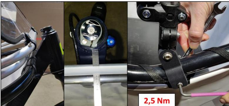
Sobald Sie den Abstand durch Verschieben der Schellen richtig eingestellt haben, ziehen Sie die beiden Schrauben mit 2,5 Nm an.
