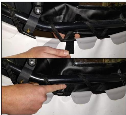
Schließen Sie abschließend noch die beiden Klettverschlüsse rechts und links vor den Befestigungsschellen der Bügel um den Schlauch der Plane.
