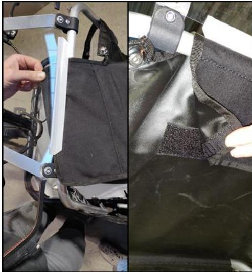
Fädeln Sie nun die Klettverschlusslasche zwischen Visier und oberen Bügel durch und schließen Sie den Klettverschluss. Achten Sie darauf, dass der Klettverschluss der Lasche mit dem festen Klettverschluss vorne abschließt.
